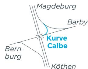
Weitere Voraussetzung ist der Bau einer Verbindungskurve bei Calbe. Diese kleine Abkürzung führt zu einer Reisezeitersparnis von ca. 8 Minuten. Auch diese Minuten sind erforderlich, um das neue Fahrplankonzept umsetzen zu können.
